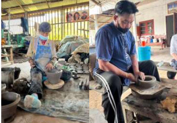
ภาพที่ 3 แป้นหมุนธรรมดา และแป้นหมุนไฟฟ้าแบบญี่ปุ่น (ที่มา: สุนิศา โปธิแสนสุข, 2566)
