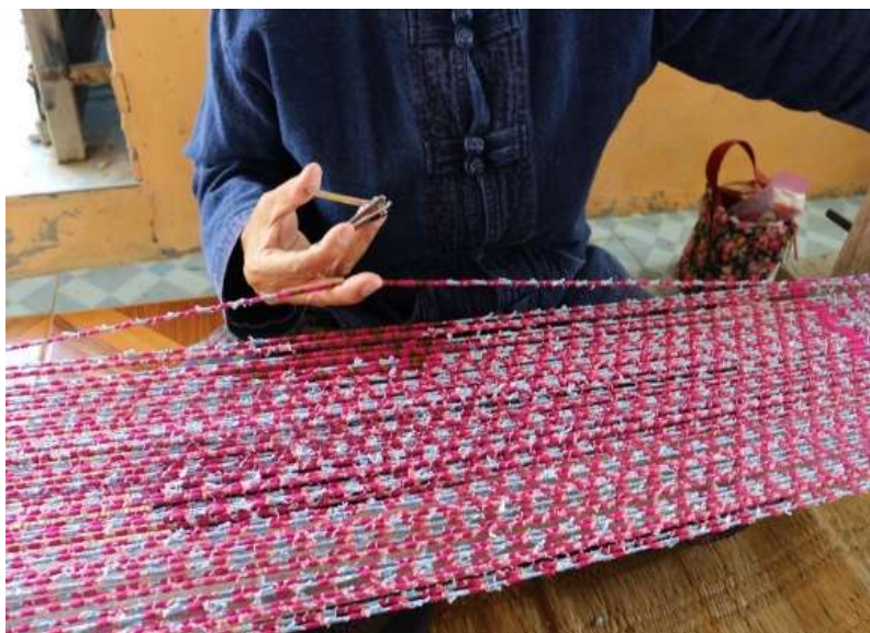
รูปภาพที่ 2 กระบวนการมัดลาย (ที่มา: สุนิศา โพธิ์แสนสุข, 2566)
