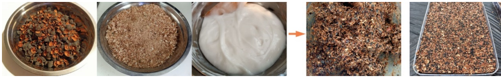
รูปภาพที่ 4 การผสมเปลือกลูกหอย ชี้เลื่อยละเอียด และตัวประสาน
