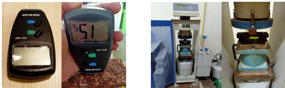
รูปภาพที่ 5 เครื่องวัดความชื้นและเครื่อง Universal Testing Machine เพื่อวัดแรงกด
