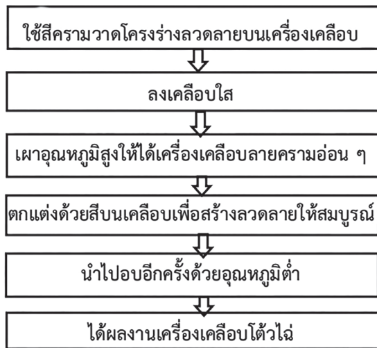
ภาพที่ 6 ลำดับขั้นตอนการลงสีได้โฉ ที่มา : หลี่หลิน, (2567).
