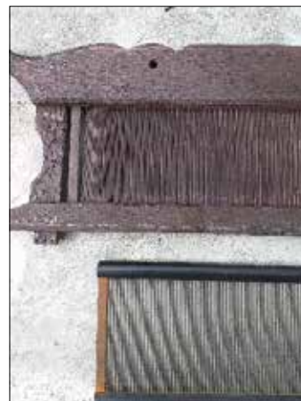
ภาพที่ 2 ภาพเปรียบเทียบฟืมไม้ (ด้านบน) และฟืมโลหะ (ด้านล่าง) ที่มา : ภาพถ่ายโดยผู้วิจัย เมื่อวันที่ 13 สิงหาคม 2562
