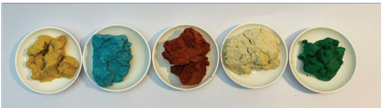
ภาพที่ 6 ปูนดำสีต่างๆ จากศูนย์การเรียนรู้งานปูนปั้น อ.ทองร่วง เอ็มโอษฐ์ แบบสั่งผลิตชนิดมีสี ที่มา : ภาพถ่ายโดยผู้วิจัย เมื่อวันที่ 19 เมษายน 2564
