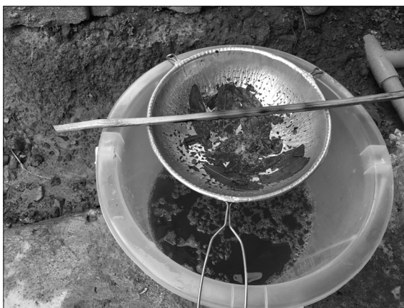
ภาพที่ 5 ภาพขั้นตอนการคัดแยกน้ำสีและกรองเศษพืช ที่มา : ภาพถ่ายโดยผู้วิจัย สิริมา สัตยาธาร เมื่อวันที่ 7 กุมภาพันธ์ 2560
