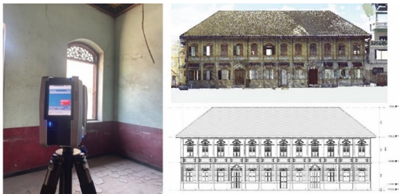
ภาพที่ 4 การทำสำรวจรังวัดอาคารโรงพิมพ์บำรุงนุกุลกิจ โดยการใช้เทคโนโลยีสแกนเนอร์เลเซอร์และอากาศยานไร้คนขับ
