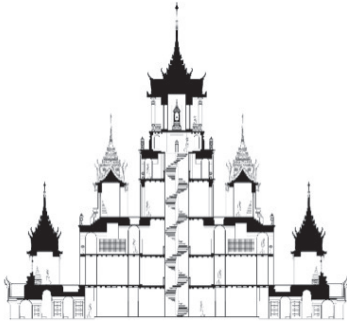
ภาพที่ 12 รูปตัดตัวอาคาร แสดงพื้นที่ใช้สอยในแต่ละชั้น ที่มา: Fine Arts Department (1995)
