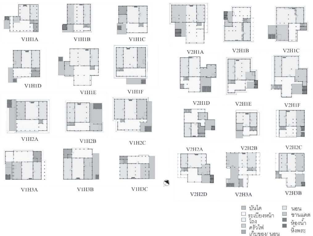
ภาพที่ 6 การวิเคราะห์องค์ประกอบของผังและพื้นที่ใช้สอยภายในเรือนในบ้านแวน (ซ้าย) และบ้านโลงนิม (ขวา)
