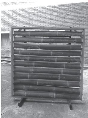
ภาพที่ 15 แสดงลักษณะบานเกล็ดไม้ไผ่ที่มีการปรับปรุงจากออกแบบด้วยวัสดุจริง
