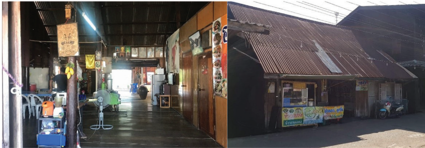
ภาพที่ 18 ตัวอย่างเรือนแถวที่มีการปรับเปลี่ยนการใช้สอยใหม่ โดยไม่กระทบกับโครงสร้างเดิม ด้วยการกั้นผนังแบ่งพื้นที่ หรือการกั้นด้วยเครื่องเรือน
