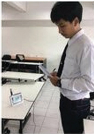
ภาพที่ 10 การวัดอุณหภูมิอากาศด้วยเครื่องมือวัด Rotronic CL11
