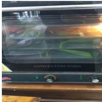
ภาพที่ 2 นำเข้าตู้อบลมร้อน อุณหภูมิ 70 องศาเซลเซียส เป็นเวลา 40 นาที
