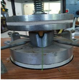
ภาพที่ 7 เมื่อได้กลีบกุหลาบ นำมาอัดในแม่พิมพ์ เครื่องอัดกลีบดอกไม้ ด้วยอุณหภูมิ 75 องศาเซลเซียส ใช้เวลา 3 นาที (กลีบดอกเล็กจะใช้เวลา 2 นาที)
