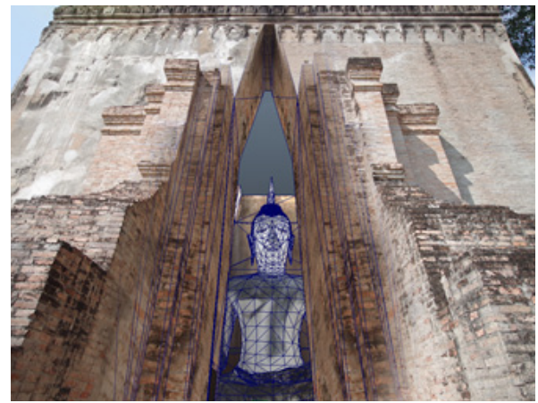
รูปที่ 7 เทคนิคการฉายภาพถ่ายดิจิตอลลงบนพื้นผิวแบบจำลองผ่านมุมมองแบบ Perspective Projection
