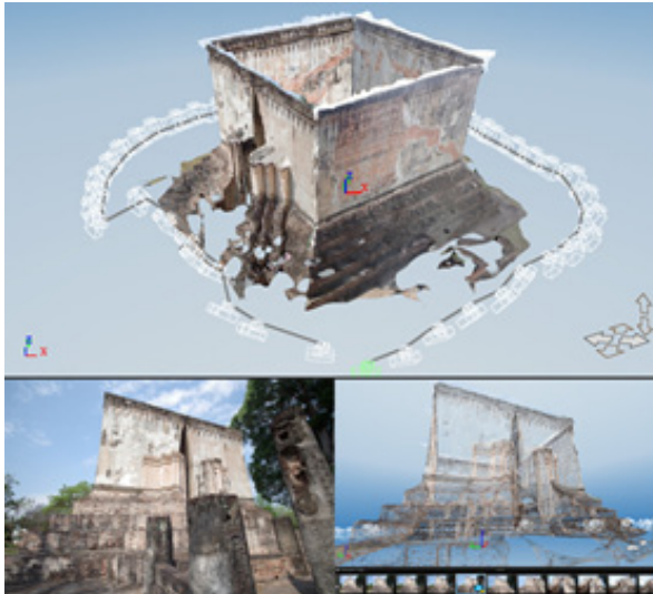
รูปที่ 5 การสร้างแบบจำลองแบบอัตโนมัติด้วยกระบวนการโฟโต้แกรมเมตรี
