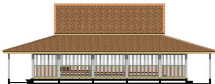
รูปที่ 12 (รูปบนซ้าย) ศาลาโรงธรรมวัดท้ายยอ อ.เมืองฯ จ.สงขลา (รูปบนขวา) ภาพสามมิติแสดงศาลาโรงธรรมวัดท้ายยอ ลักษณะเป็นศาลา โถงมาแต่เดิม ต่อมาจึงมาสร้างผนังเป็นซี่ไม้ผสมเหล็กเส้นล้อมรอบ (รูปล่างซ้าย) แบบสถาปัตยกรรมรูปด้านหน้าอาคารศาลาโรงธรรม ท้ายยอ (รูปล่างขวา) แบบสถาปัตยกรรมรูปด้านข้างอาคารศาลาโรงธรรมวัดท้ายยอ
