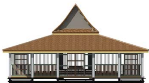
รูปที่ 12 (รูปบนซ้าย) ศาลาโรงธรรมวัดท้ายยอ อ.เมืองฯ จ.สงขลา (รูปบนขวา) ภาพสามมิติแสดงศาลาโรงธรรมวัดท้ายยอ ลักษณะเป็นศาลา โถงมาแต่เดิม ต่อมาจึงมาสร้างผนังเป็นซี่ไม้ผสมเหล็กเส้นล้อมรอบ (รูปล่างซ้าย) แบบสถาปัตยกรรมรูปด้านหน้าอาคารศาลาโรงธรรม ท้ายยอ (รูปล่างขวา) แบบสถาปัตยกรรมรูปด้านข้างอาคารศาลาโรงธรรมวัดท้ายยอ
