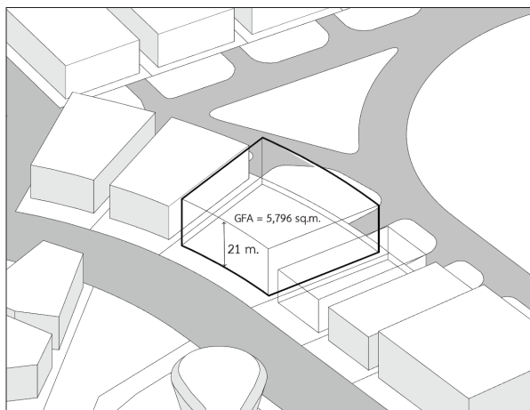
รูปที่ 8 (ซ้าย) แสดงข้อกำหนดของที่ตั้งอาคารศาลาไทยประกอบด้วย ขนาดที่ดิน ระยะร่นโดยรอบ และความกว้าง ความยาวหลังคิระยะร่น (ขวา) แสดงขนาดพื้นที่อาคารที่สร้างได้ และความสูงที่กำหนด ((left) Shows the requirements for the location of the Thailand Pavilion, consisting of land size, surrounding recession and width, length after recession. (right) Showing the building area that can be built. and height determined)
