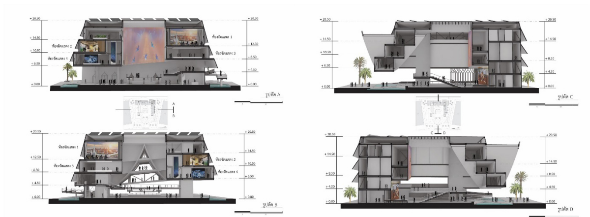
รูปที่ 24 (บนซ้าย) รูปตัด A. (ล่างซ้าย) รูปตัด B. (บนขวา) รูปตัด C. (ล่างขวา) รูปตัด D (Shows an sections of Thailand Pavilion for World Expo 2020 Dubai. (Top left) Section A. (Bottom left) section B. (Top right) Section C. (Bottom right) Section D.)
