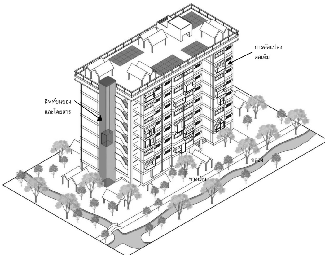
รูปที่ 20 อาคาร 8 ชั้น แสดงการต่อเติมที่ระเบียงและส่วนนอกอาคารตามความเหมาะสมของแต่ละครอบครัว ที่ว่างเปิดโล่งปลูกต้นไม้โดยรอบอาคาร และดาดฟ้าอาคาร รวมถึงศาลากิจกรรมและคลอง (Eight-floors condominium with flexibility of terrace and façade expansion, open space with trees around building and roof deck including various-activities shelters and canals)
