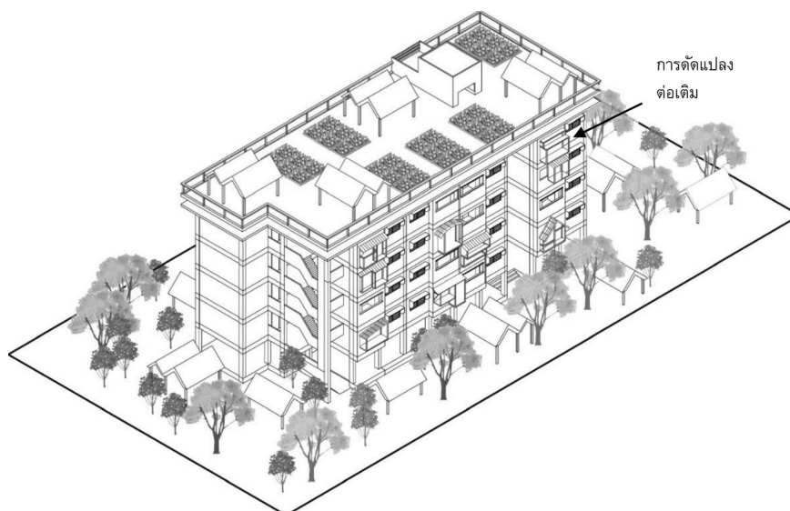
รูปที่ 17 อาคาร 5 ชั้น แสดงการต่อเติมที่ระเบียงและส่วนนอกอาคาร ตามความเหมาะสมของแต่ละครอบครัว ที่ว่างเปิดโล่งโดยรอบอาคาร และดาดฟ้าอาคาร (Five-floors condominium with flexibility of terrace and façade expansion, open space around building and roof deck)
