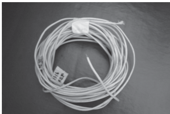
รูปที่ 2 สายวัดอุณหภูมิชนิดเทอร์โมคอปเปิล แบบ เค (thermocouple type k)
