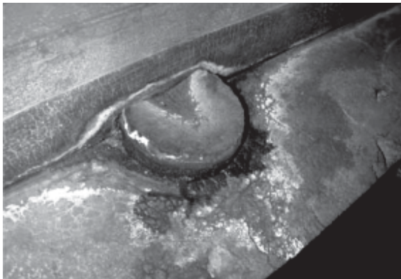
รูปที่ 10 ความชื้นทำให้เกิดเชื้อราที่พื้นผิวของอุปกรณ์ในระบบปรับอากาศ
