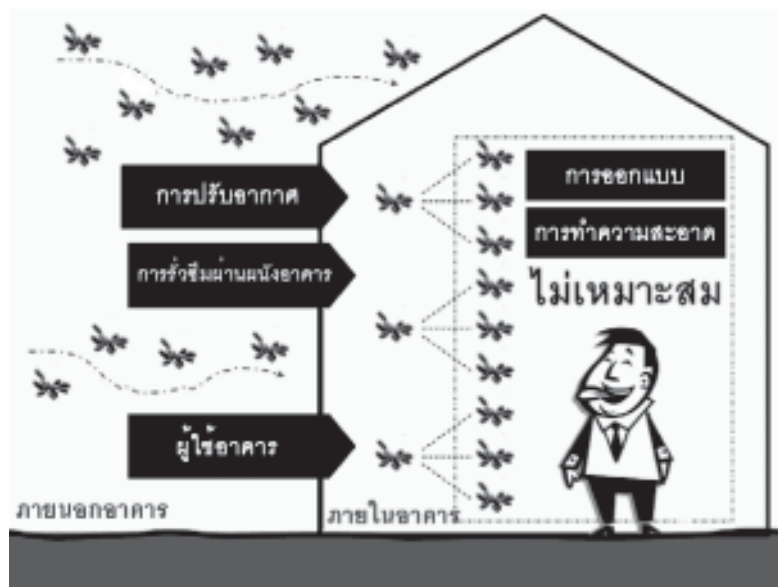
รูปที่ 1 สาเหตุและปัจจัยที่ทำให้เกิดการสะสมของเชื้อโรภายในอาคาร
