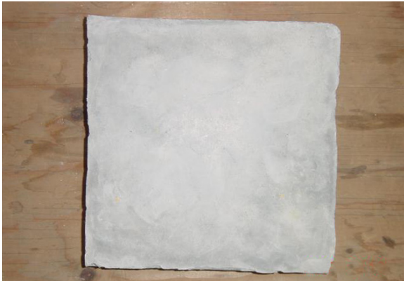
รูปที่ 1 แผ่นคอนกรีตทดสอบ
