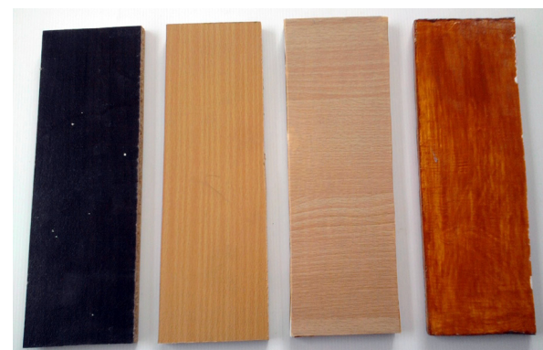
รูปที่ 10 ลักษณะสี ผิว ของไม้อัดและวัสดุที่พัฒนาใหม่
