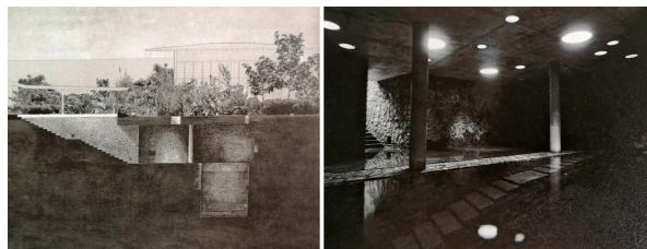
รูปที่ 7 บ้าน Tara House (ภาพตัดตามขวาง (section) แสดง แหล่งน้ำเดิมใต้อาคาร, พื้นที่แหล่งน้ำเดิม (Baoli) และ ถูกพัฒนาเป็นสระน้ำใต้ดินภายในอาคาร) (Cross section of Tara House represents underground pool with the phenomenal of light)
