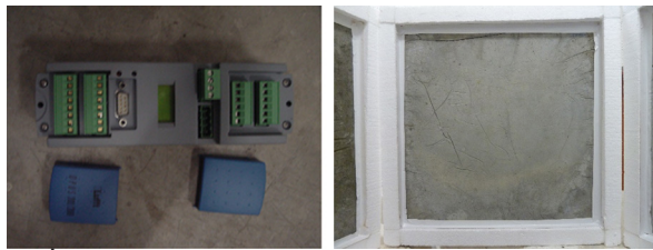
รูปที่ 6 แสดงอุปกรณ์บันทึกข้อมูล (data logger) และกล่องทดสอบ (The data logger and testing box)
