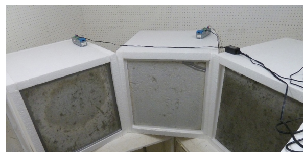
รูปที่ 4 แสดงส่วนประกอบของกล่องทดสอบและการติดตั้งแผ่นวัสดุที่หันด้านเข้าสู่แหล่งความร้อน (The components of the testing box and the installation of the material facing the heat source)
