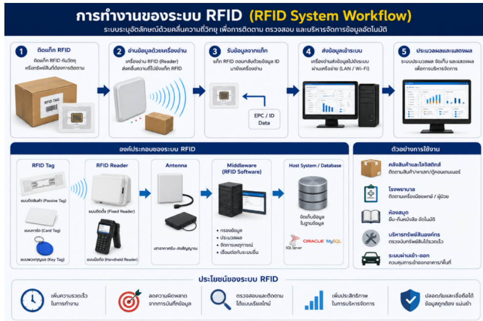
ภาพที่ 5 ภาพจำลองการทำงานของระบบ RFID (Quiroz–Flores et al., 2023; Ferdousmou et al., 2024)
