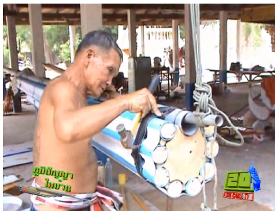
ภาพที่ 1 การนำลูกบั้งไฟมาประกอบเข้ากับเลาบั้งไฟ
