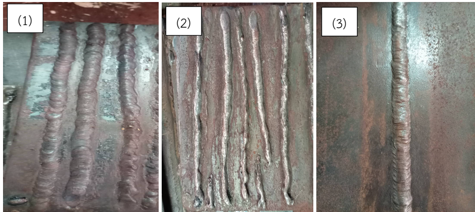
ภาพที่ 2: ตัวอย่างงานเชื่อมโลหะของนักเรียนหลักสูตรประกาศนียบัตรวิชาชีพสาขาช่างเชื่อม ชั้นปีที่ 1 (1 และ 2) เปรียบเทียบกับการเชื่อมโลหะที่มีคุณภาพ (3)
