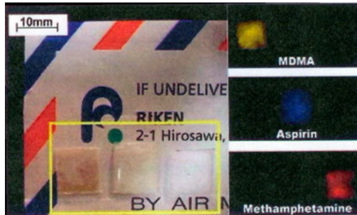
ภาพที่ 4 การตรวจด้วยเทคโนโลยีคลื่นเทระเฮิรตซ์ในการตรวจจับหาสารเสพติด
