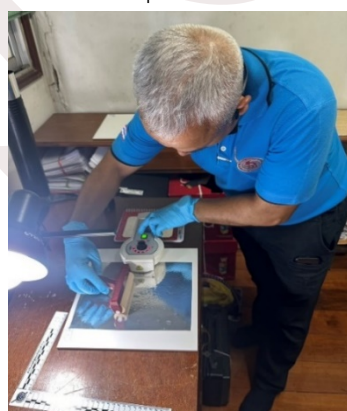
ภาพที่ 3 เครื่องลอกรอยฝุ่นแบบไฟฟ้าสถิต จากคณะนิติวิทยาศาสตร์ โรงเรียนนายร้อยตำรวจ (ซ้าย) การลอกรอยร่องเท้าเป็นฝุ่น (กลาง) และการถ่ายภาพรอยร่องเท้าเป็นฝุ่นที่ตรวจเก็บได้ (ขวา) ณ ห้องปฏิบัติการ พิสูจน์หลักฐานจังหวัดราชบุรี
