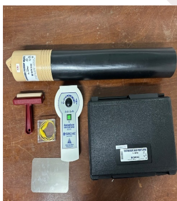
ภาพที่ 3 เครื่องลอกรอยฝุ่นแบบไฟฟ้าสถิต จากคณะนิติวิทยาศาสตร์ โรงเรียนนายร้อยตำรวจ (ซ้าย) การลอกรอยร่องเท้าเป็นฝุ่น (กลาง) และการถ่ายภาพรอยร่องเท้าเป็นฝุ่นที่ตรวจเก็บได้ (ขวา) ณ ห้องปฏิบัติการ พิสูจน์หลักฐานจังหวัดราชบุรี
