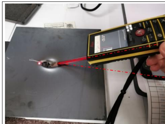
ภาพที่ 2 การวัดแบบการกำหนดจุดแรกเข้า ค่ามุมยิงที่วัดได้เทียบกับระนาบของแผ่นโลหะได้มุม 25 องศา
