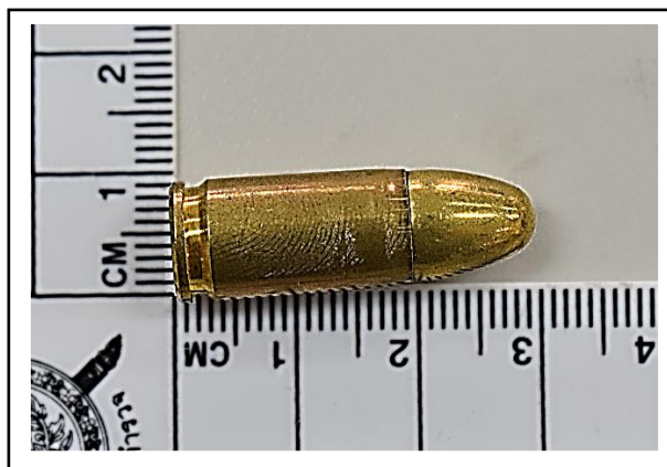
ภาพที่ 5 การปรากฏของรอยลายนิ้วมือแฝงบนลูกกระสุนปืนขนาด 9 มิลลิเมตร ที่ช่วงความชื้นสัมพัทธ์ 25% โดยใช้วิธีรมแก๊สด้วยซูเปอร์กลู (Super Glue)
