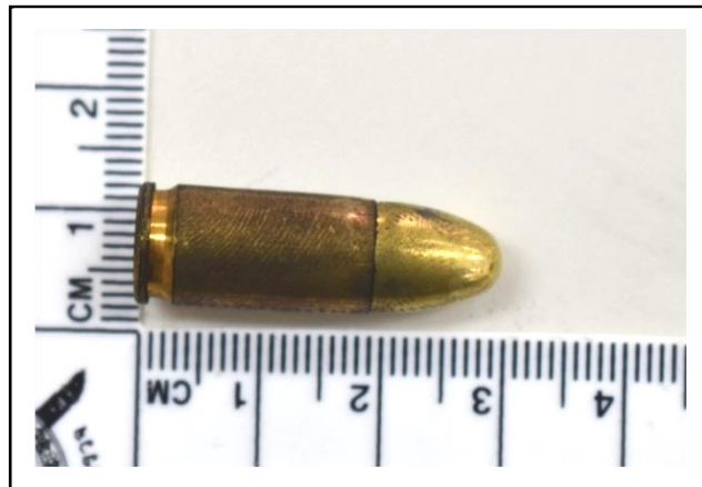
ภาพที่ 4 การปรากฏของรอยลายนิ้วมือแฝงบนลูกกระสุนปืนขนาด 9 มิลลิเมตร ที่ช่วงความชื้นสัมพัทธ์ 75% ด้วยวิธีการปิดผงฝุ่นโดยการปิดผงฝุ่นดำ (Black Powder)
