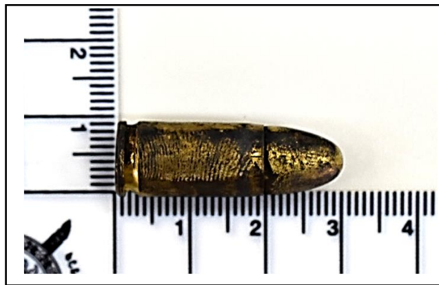
ภาพที่ 10 การปรากฏของรอยลายนิ้วมือแฝงบนลูกกระสุนปืนขนาด 9 มิลลิเมตร ที่ช่วงความชื้นสัมพัทธ์ 75% โดยใช้วิธีชุบสารเคมีเพอร์มาบลู (Perma Blue)
