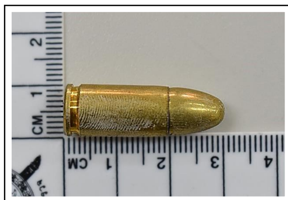
ภาพที่ 7 การปรากฏของรอยลายนิ้วมือแฝงบนลูกกระสุนปืนขนาด 9 มิลลิเมตร ที่ช่วงความชื้นสัมพัทธ์ 75% โดยใช้วิธีรมแก๊สด้วยซูเปอร์กลู (Super Glue)
