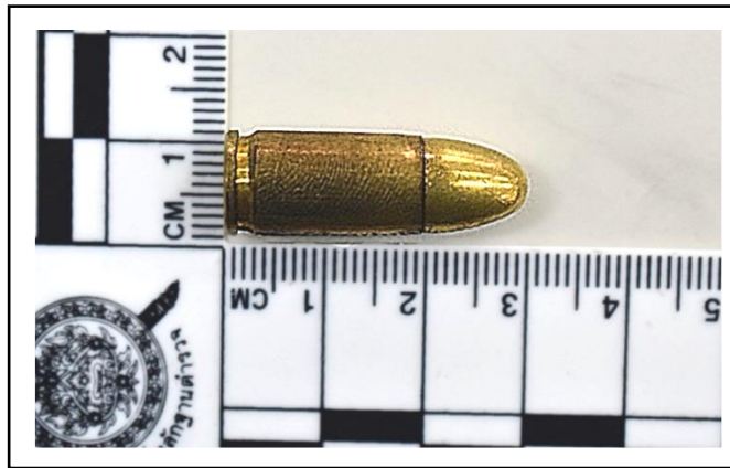
ภาพที่ 1 การปรากฏของรอยลายนิ้วมือแฝงบนลูกกระสุนปืนขนาด 9 มิลลิเมตร ที่ช่วงความชื้นสัมพัทธ์ 25% ด้วยวิธีการปิดผงฝุ่นโดยการปิดผงฝุ่นดำ (Black Powder)
