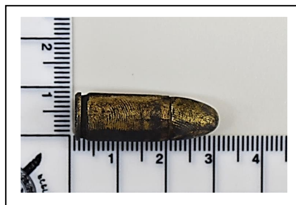
ภาพที่ 8 การปรากฏของรอยลายนิ้วมือแฝงบนลูกกระสุนปืนขนาด 9 มิลลิเมตร ที่ช่วงความชื้นสัมพัทธ์ 25% โดยใช้วิธีชุบสารเคมีเพอร์มาบลู (Perma Blue)
