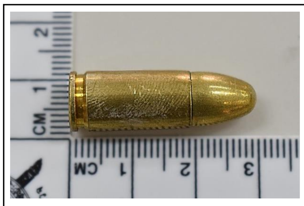
ภาพที่ 6 การปรากฏของรอยลายนิ้วมือแฝงบนลูกกระสุนปืนขนาด 9 มิลลิเมตร ที่ช่วงความชื้นสัมพัทธ์ 50% โดยใช้วิธีรมแก๊สด้วยซูเปอร์กลู (Super Glue)
