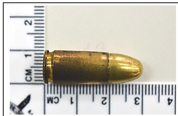
ภาพที่ 2 การไม่ปรากฏของรอยลายนิ้วมือแฝงบนลูกกระสุนปืนขนาด 9 มิลลิเมตร ที่ช่วงความชื้นสัมพัทธ์ 25% ด้วยวิธีการปิดผงฝุ่นโดยการปิดผงฝุ่นดำ (Black Powder)
