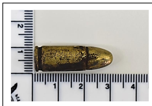
ภาพที่ 9 การปรากฏของรอยลายนิ้วมือแฝงบนลูกกระสุนปืนขนาด 9 มิลลิเมตร ที่ช่วงความชื้นสัมพัทธ์ 50% โดยใช้วิธีชุบสารเคมีเพอร์มาบลู (Perma Blue)
