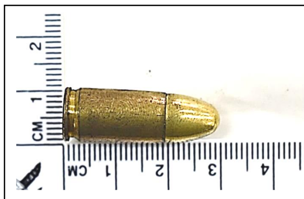
ภาพที่ 3 การปรากฏของรอยลายนิ้วมือแฝงบนปลอกลูกกระสุนปืนขนาด 9 มิลลิเมตร ที่ช่วงความชื้นสัมพัทธ์ 50% ด้วยวิธีการปิดผงฝุ่นโดยการปิดผงฝุ่นดำ (Black Powder)
