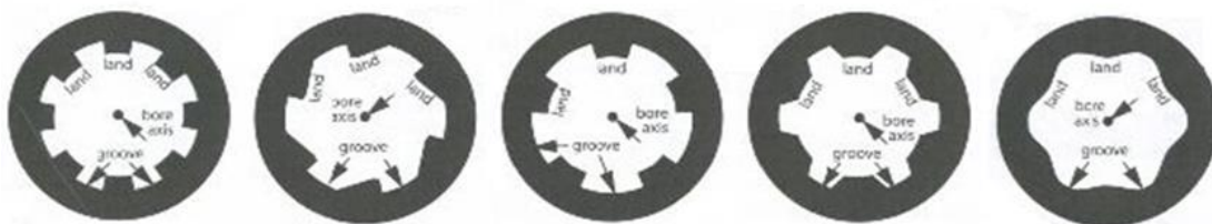
ภาพที่ 3 ร่องเกลียวและสันเกลียวภายในลำกล้องปืนแบบ Conventional Rifling, Ratchet Rifling, Enfield Rifling, Hybrid Rifling และ Polygonal Rifling จากซ้ายไปขวาตามลำดับ (Brian J. Heard, 2008)
