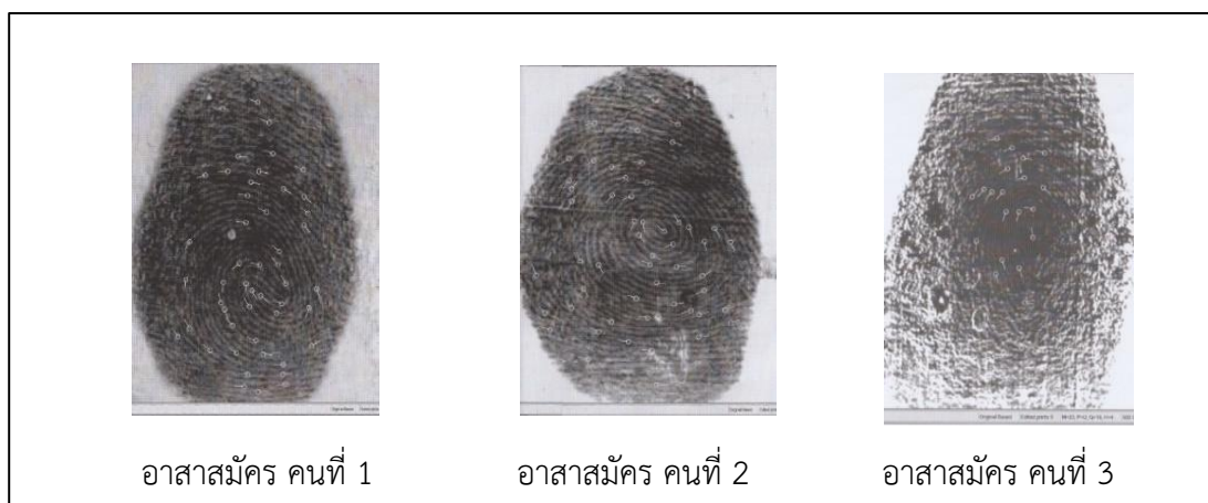
ภาพที่ 5 ตัวอย่างรอยลายนิ้วมือแฝงที่ปรากฏบนแผ่นโลหะอลูมิเนียม โดยวิธีปัดผงฝุ่นดำ ในวันที่ 10
