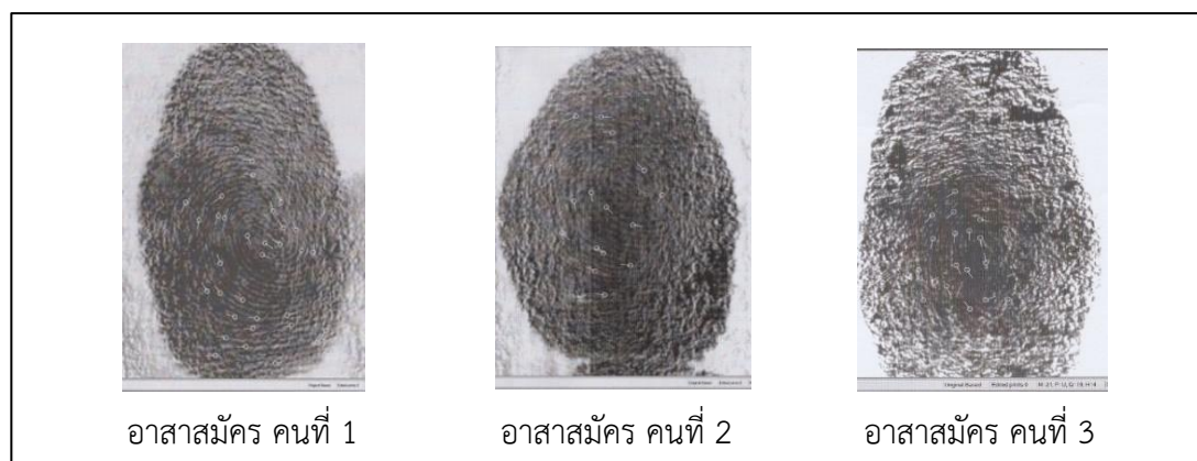
ภาพที่ 3 ตัวอย่างรอยลายนิ้วมือแฝงที่ปรากฏบนแผ่นโลหะอลูมิเนียม โดยวิธีปัดผงฝุ่นดำ ในวันที่ 3
