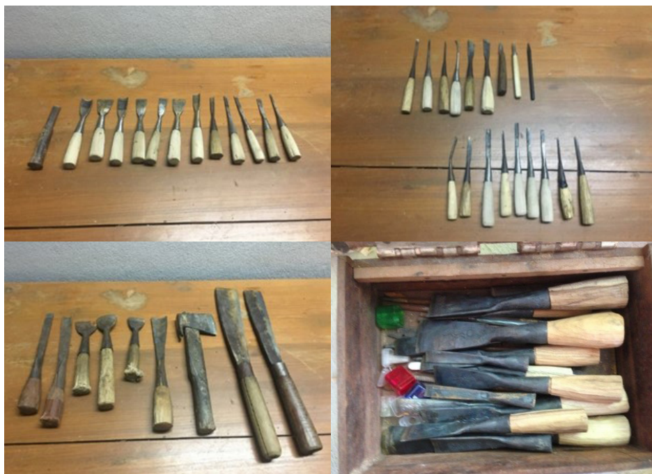
ภาพที่ 27 เครื่องมือในการแกะสลักพระพุทธรูป และการตัดสรไม้วัดถุดิบ Note: From © Aekapong Rounoon 10/03/2017
