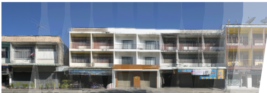
ภาพที่ 9 ตัวอย่างภาพถ่ายที่ได้ปรับแต่งทัศนมิติและรายละเอียดอื่นๆ แล้วนำมาวางซ้อนกันตามความเหลื่อมซ้อนจากกระบวนการถ่ายภาพ
