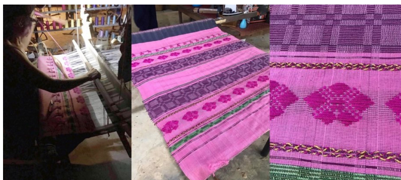
ภาพที่ 7 ผ้าฝ้ายแกมแฝกผสมเทคนิคการทอจกลายดอกแก้วและทอแทรกเปียแฝก (© Naddawadee Boonyadacho 23/06/2020)
