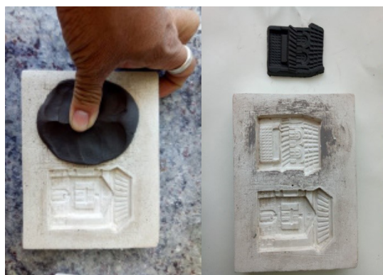
ภาพที่ 12 แสดงการกดดิน และชิ้นงานหลังถอดจากพิมพ์ปูนปลาสเตอร์ (© Thapanut Kaewpan 19/05/2021)
