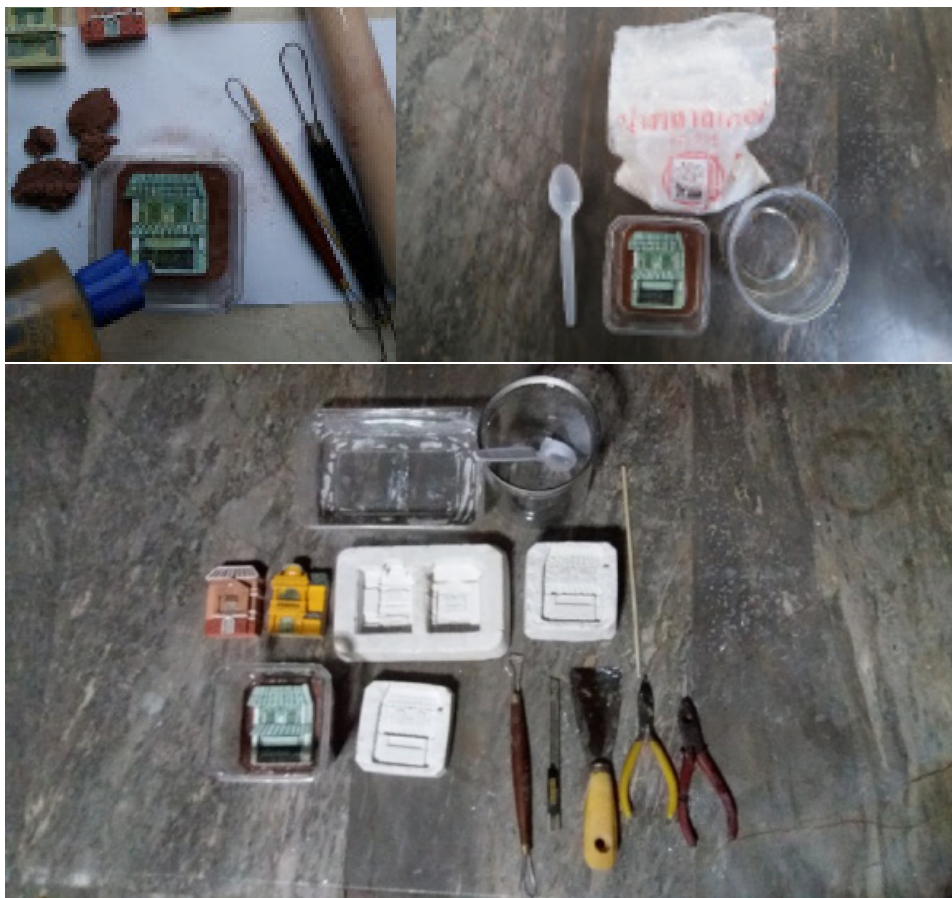
ภาพที่ 4 ขั้นตอนการทำพิมพ์ปูนปลาสเตอร์ ใช้น้ำยาล้างจานเคลือบกันติด ผสมปูนปลาสเตอร์ เทหล่อพิมพ์ในกรอบวัสดุที่หาได้รอบตัว (© Thapanut Kaewpan 19/05/2021)
