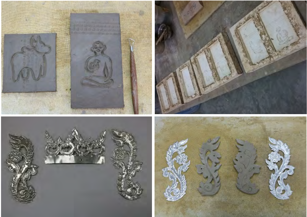
ภาพที่ 23 การสร้างแม่พิมพ์ของการทำกระเบื้องดินเผาและเครื่องประดับปานซอย (© Pakit Bunsut 20/01/2018)
