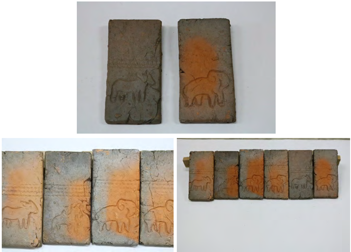
ภาพที่ 25 การทดลองและเรียงสีเเผาะกระเบื้องดินเผา (© Pakit Bunsut 18/05/2018)
