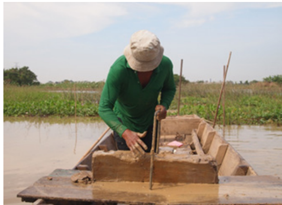
ภาพที่ 6 การตัดแบ่งดินเป็นแท่งเล็ก (© Kanoknat Promnakon 18/03/2016)
