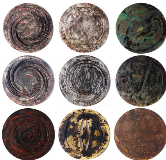
ภาพที่ 1 ต้นแบบทดสอบโครงสร้างและการตกแต่งผิวด้วยยางรัก ตามแนวทางทดลองที่ 1 และ 3
