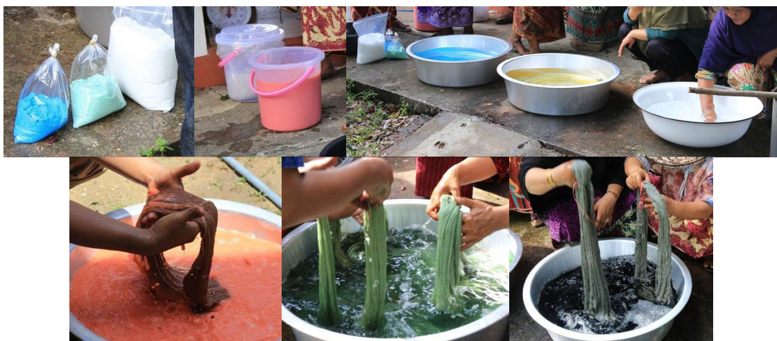
ภาพที่ 13 การใช้มอร์แดนต์เพื่อการติดสี หรือสารกระตุ้นสีที่เปลี่ยนค่าเฉดสีในการย้อม
