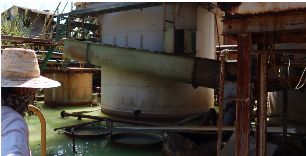
ภาพที่ 3 ภาพถ่ายของพื้นที่เหมืองฯ แสดงให้เห็นบริเวณที่สารเคมีไหลลงสู่พื้นดิน
