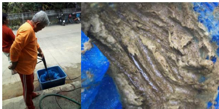
ภาพที่ 11 การแยกเส้นใยเพื่อผลิตเยื่อกระดาษด้วยเครื่องฉีdnน้ำแรงดันสูง (© Vuthipong Roadkasemsri 16/04/2019)
