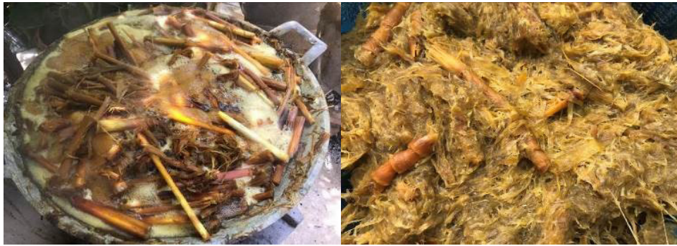
ภาพที่ 4 การแยกเส้นใยเพื่อผลิตเยื่อกระดาษด้วยวิธีต้มกับโซเดียมไฮดรอกไซด์ (© Vuthipong Roadkasemsri 15/04/2019)
