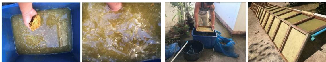
ภาพที่ 7 การขึ้นรูปกระดาษข้าวโพดด้วยการช้อนเยื่อและการตากกระดาษ (© Vuthipong Roadkasemsri 17/04/2019)
