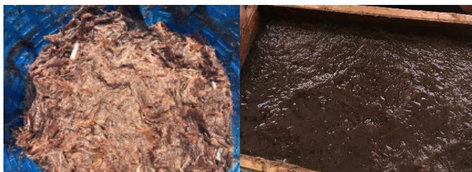
ลักษณะเยื่อกระดาษก่อนใช้น้ำแรงดันสูง ในการย่อยเยื่อกระดาษ
