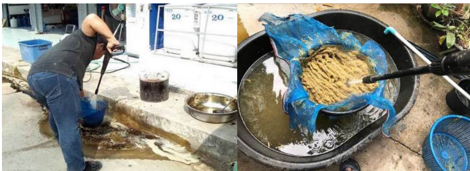
ภาพที่ 5 การย่อยเส้นใยเพื่อผลิตเยื่อกระดาษด้วยเครื่องฉีdnน้ำแรงดันสูง © Vuthipong Roadkasemsri 16/04/2019
