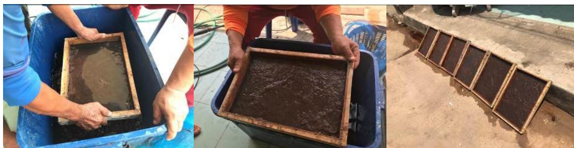
ภาพที่ 13 การขึ้นรูปกระดาษจากกาก้วยด้วยการช้อนเยื่อและการตากกระดาษ (© Vuthipong Roadkasemsri 17/04/2019)
