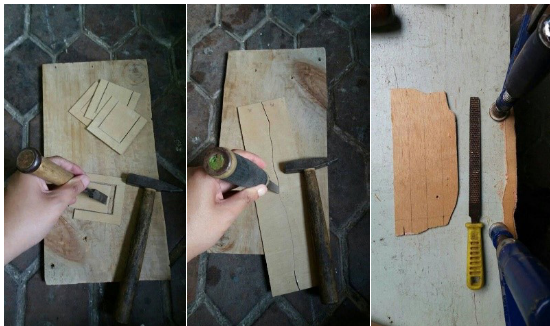
ภาพที่ 10 แสดงการเซาะร่องตัดวัสดุด้วยสิ่ว และการตกแต่งผิวด้วยสิ่วหรือด้วยตะไบ (© Thapanut Kaewpan 2020)
