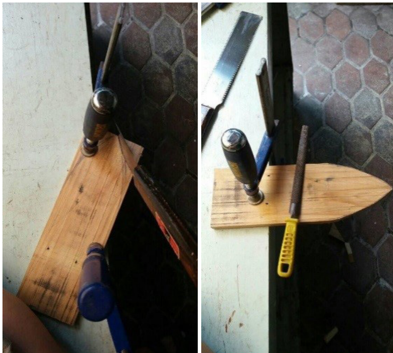
ภาพที่ 8 แสดงการตัดวัสดุ (ด้วยเลื่อยสองทาง) ที่มีความหนา เพื่อเข้าทรงโค้ง และการแต่งผิวด้วยตะไบ (© Thapanut Kaewpan 2020)
