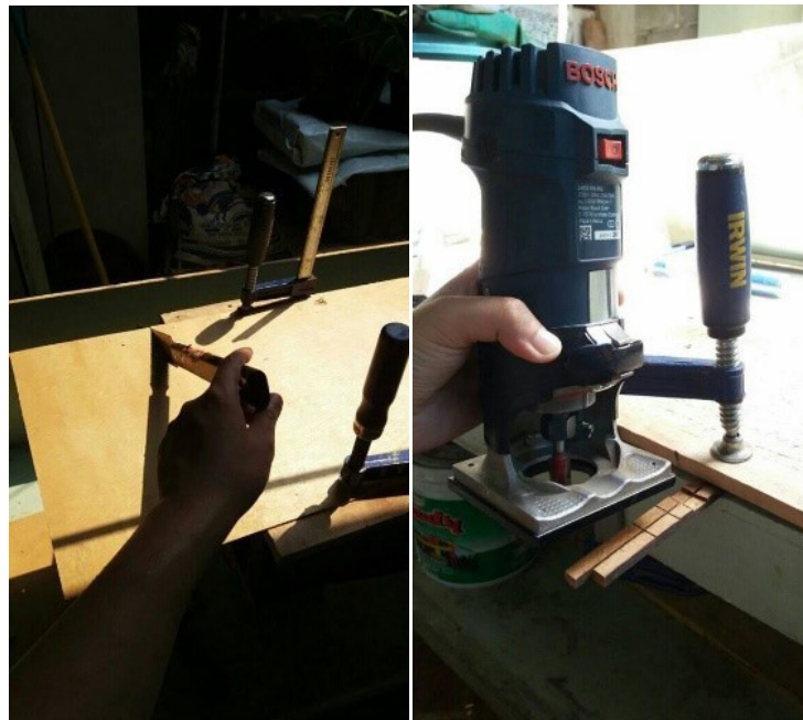
ภาพที่ 9 แสดงองศาการตัดด้วยเลื่อยสองทาง และการเซาะร่องด้วย trimmer (© Thapanut Kaewpan 2020)
