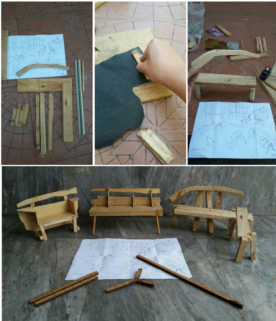
ภาพที่ 11 แสดงการขัดแต่งด้วยกระดาษทรายและการเตรียมก่อนการประกอบชิ้นงาน
