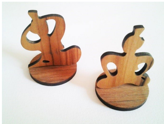
ภาพที่ 1 ตัวอย่างการใช้เลเซอร์ตัดแผ่นไม้บางด้วยคอมพิวเตอร์ CNC (© Aran Wanichakorn 01/02/2018)
