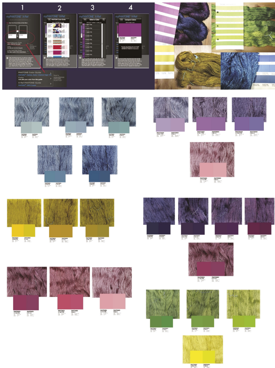
ภาพที่ 2 ตัวอย่างวิธีการเทียบค่าสีในโปรแกรม Pantone ในโปรแกรมคอมพิวเตอร์ และการนำเส้นไหมย้อมสีเปรียบเทียบกับ Pantone (source: Rujinarong 2018 , 90 - 95)
