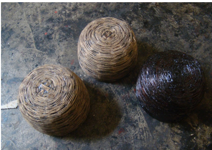
ภาพที่ 2 โครงก๊อกที่สานขึ้นรูปและนำไปสู่กระบวนการทายางรักเรียบร้อยแล้ว 1 รอบ (© Thapakorn Khruearaya 11/11/2017)
