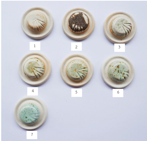
ภาพประกอบที่ 3 ผลการทดลองเคลือบซีเถ้าคราม อุณหภูมิ 1,230 องศาเซลเซียส บรรยากาศสันดาปไม่สมบูรณ์ (Reduction)
