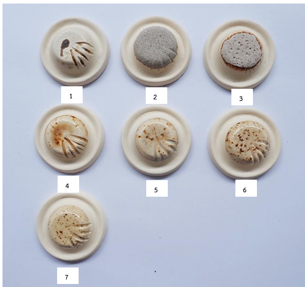
ภาพประกอบที่ 2 ผลการทดลองเคลือบซีเมนต์คราม อุณหภูมิ 1,230 องศาเซลเซียส บรรยากาศสันดาปสมบูรณ์ (Oxidation)
