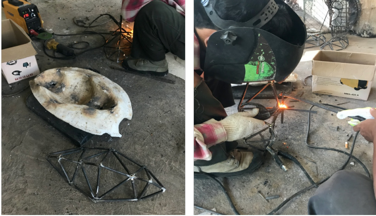
ภาพประกอบที่ 14 การเชื่อมเหล็กเส้นจากแม่พิมพ์
