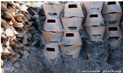
ภาพประกอบที่ 4 ผลิตภัณ์จากการเผาจากเตาเผาแบบดั้งเดิมเผาที่อุณหภูมิ 750 องศาเซลเซียส
