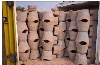
ภาพประกอบที่ 5 ผลิตภัณ์จากนวัตกรรมเตาพญาล่เผาที่อุณหภูมิ 750 องศาเซลเซียส
