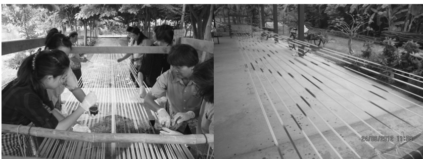
ภาพที่ 4 การแต้มสีลงบนเส้นยืนสำหรับทอโดยตรง
