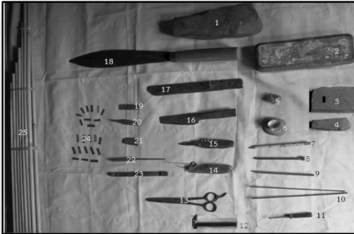
ภาพประกอบ 12 อุปกรณ์ทำแคนของช่างทำแคนบ้านนาพอน เมืองไม้เคา จังหวัดห้วยบงที่ประเทศเวียดนาม จากภาพประกอบ พบเครื่องมือที่ใช้ทำแคนของช่างทำแคน ดังนี้
